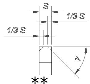
Dentatura alternata per tubi spessore < 2 mm.
