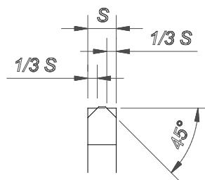
Dentatura tipo Heller per pieni e tubi spessore > 2 mm.
